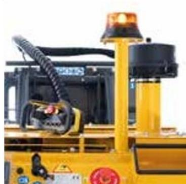
Aspiración del motor con pre-filtro ciclónico para una máxima limpieza del aire.
